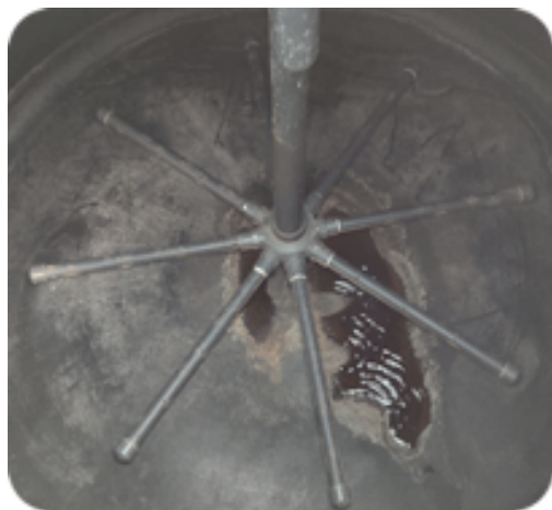
Sistema di areazione artigianale realizzato con tubi in pvc forati
