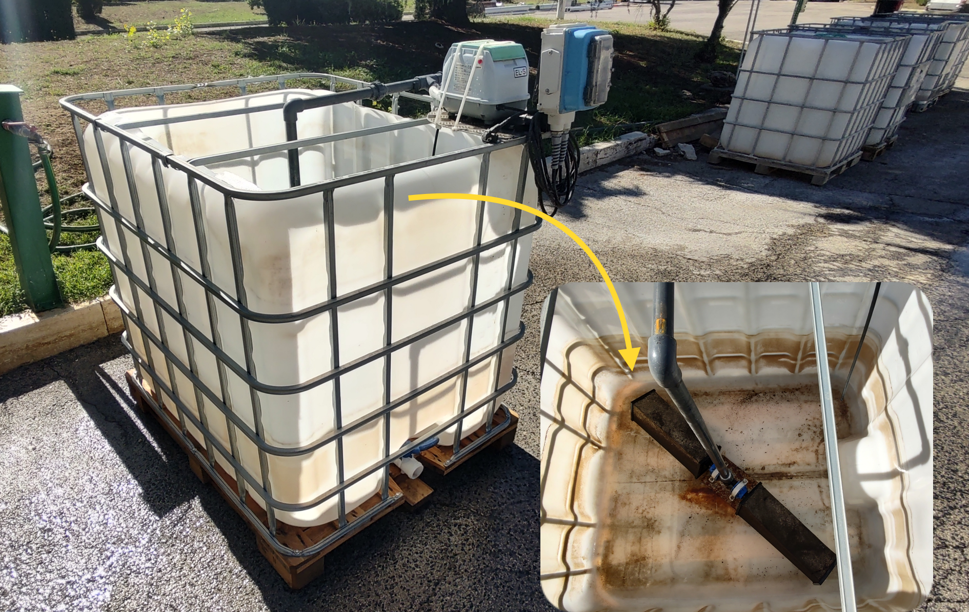
Predisposizione di una vasca da 1000l, con pompa d'aria e sistema di areazione. In questo caso per l'areazione è stato utilizzato un micro-diffusore commerciale a spugna.
